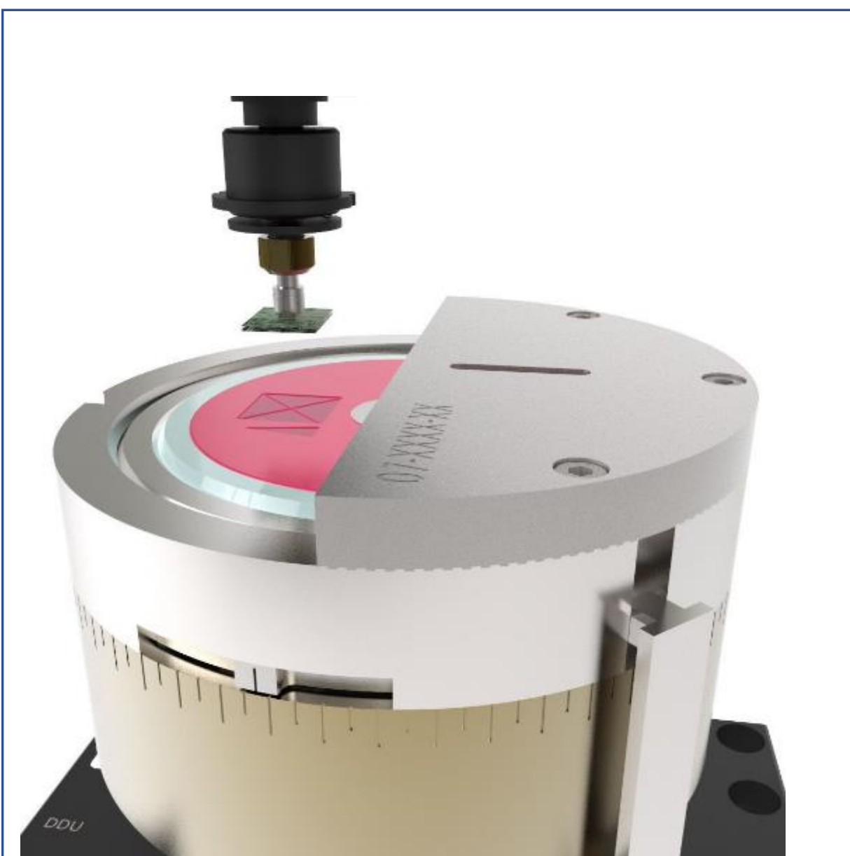
Direktdosierstation (DDU S3-006) mit Kreuzgeometrie auf der Strukturplatte
