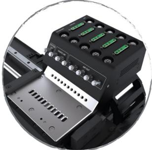
Diese Konsole ermöglicht dir echte Plug&Play Fähigkeit aller Module auf allen Anlagen. Ausgenommen sind Lasermodule auf der Pocket und D1, da hier kein Laserschutzglas an den Anlagen integrierbar ist.
